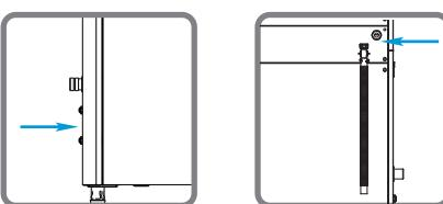
4)排水口通过排水软管接下水道
