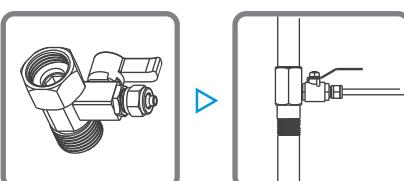
3) 自来水口、浓缩水口分别接2分PE管。浓缩水PE管另一端接下水道，用扎带固定；三通接头一外牙接头装铜螺母，内牙接口装上密封垫后，其组件与排蒸汽口连接（螺母朝上）；将卡箍套在排蒸汽软管上，然后将软管套在三通接头剩下的接口，移动卡箍将其固定。
