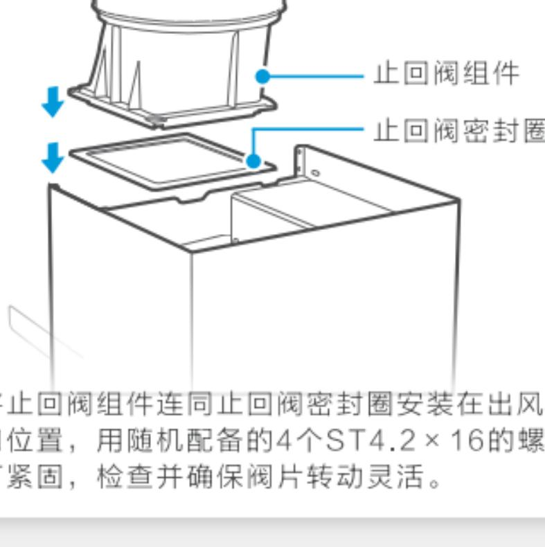
将止回阀组件连同止回阀密封圈安装在出风口位置，用随机配备的4个ST4.2×16的螺钉紧固，检查并确保阀片转动灵活。
