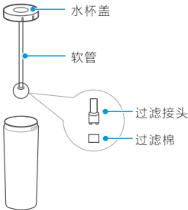
更换过滤棉：打开水杯盖，在软管底部的过滤接头处取下过滤棉进行更换。
