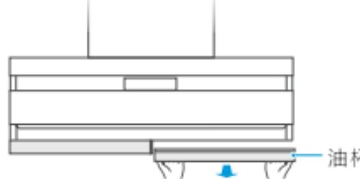
双手水平抽出油杯，分别倒掉两个油杯的积油。
