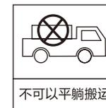
△注意 在移动或搬运冰箱如调整摆放位置、搬家时, 需提前取出冰箱内所有食品, 用胶带将玻璃搁架等易移动的配件固定好, 关紧并用胶带固定冰箱门, 搬运过程中, 底部翘起角度不可大于45°, 也不可以平躺搬运。
