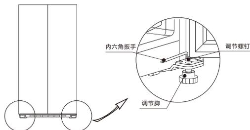
方法: 冰箱共计2个调平脚, 顺时针旋转调平脚, 冰箱升高; 逆时针旋转调平脚, 冰箱降低。
