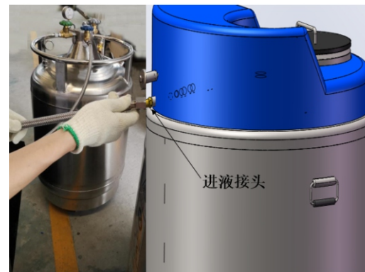
图4 自增压补液罐连接
