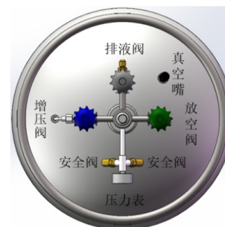
图5 自增压容器各阀门示意
