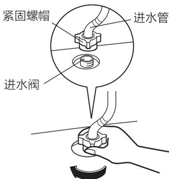
注：安装完毕后，请打开水龙头，检查是否漏水。
