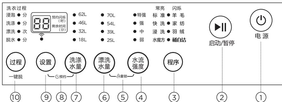
1. 电源键，连续按该键，即可打开电源或关闭电源。
