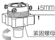
1. 旋松紧固螺母，使螺纹露出约5毫米。
