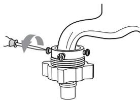
3. 将连接座套在水龙头上，均匀拧紧螺钉。
