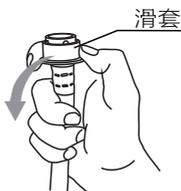
5. 下压滑套，将进水管插入连接座。
