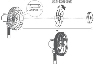
4.2 用手将风叶锁母固定在电机轴上，另一只手顺时针旋转风叶，将风叶锁母锁紧。
