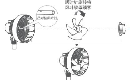
4.2 用手将风叶锁母固定在电机轴上, 另一只手顺时针旋转风叶, 将风叶锁母锁紧。
