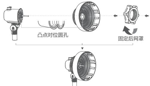
3.2 将电机前壳下方凸点与后网罩圆孔对位, 并挂在电机上。
