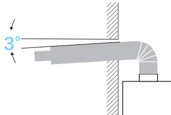
烟管必须密封，烟管使用的材料能抵抗一般的机械变形，而且应能耐热、阻燃和防腐蚀。烟管的接口必须采取密封措施，任何密封接口的材料应是耐热和防锈的。
