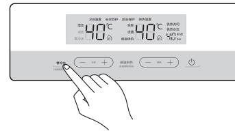
注：零冷水循环一次所需时间约为4min，且可以由售后工程师按照实际情况修改。
