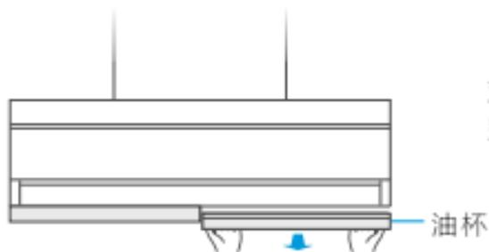
双手水平抽出油杯，分别倒掉两个油杯的积油。
