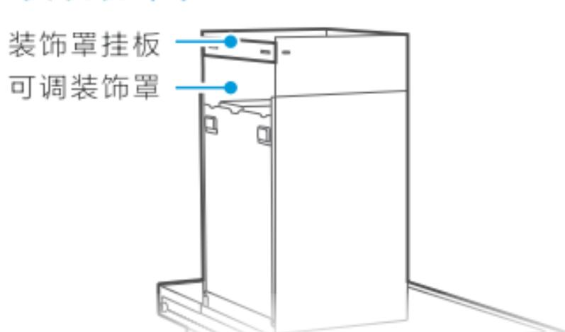
根据可调装饰罩所需安装高度，在墙壁相应位置钻出2个直径为8mm、深度为50mm的孔，将膨胀管压入孔内，再用随机配备的2颗M5 × 50沉头木螺钉将装饰罩挂板可靠固定。将可调装饰罩调至对应高度，并用随机配备的ST4.2 × 9.5自攻螺钉紧固在挂板上。
