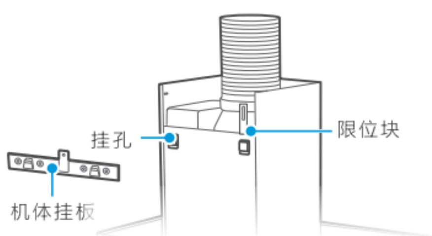
将机体后部的挂孔对准机体挂板的挂钩，从上往下挂入确认机体安装水平和牢固，再将随机所附的M5 × 16螺钉装入机体挂板顶部螺钉孔内，将限位块顶住烟机，并用M5\*45扁圆头螺钉将限位块可靠固定，防止机器意外脱落。
