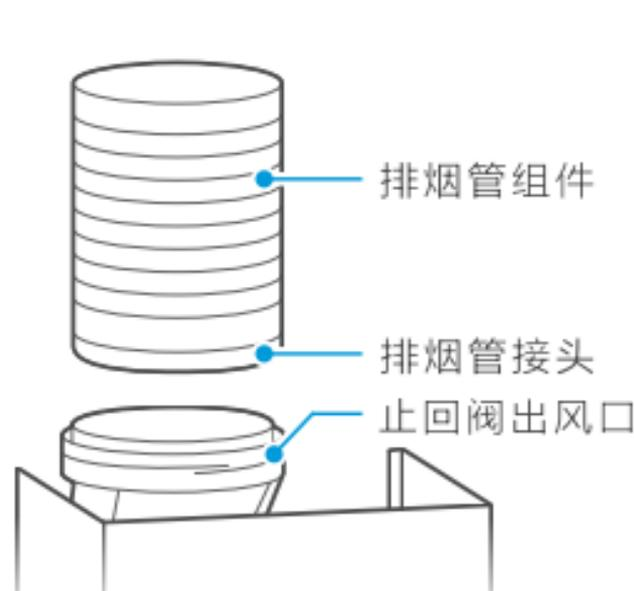
将排烟管一端插入止回阀凹槽内，用随机配送的ST2.9 × 9.5自攻螺钉将排烟管固定在止回阀中，再用排烟管上的铝箔胶带缠绕在止回阀与排烟管的安装接头处。再将排烟管的另一端引至室外或者公共烟道中。
