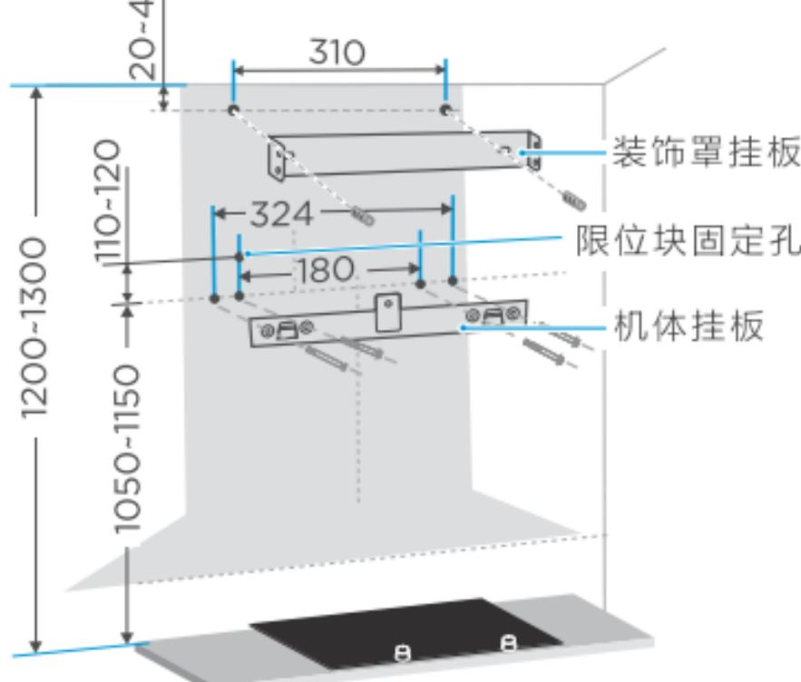
按图示在墙壁相应位置转出5个直径为10mm，深度为50-60mm的孔，其中上侧的单独孔用来固定限位块。将塑料膨胀管压入孔内，再用随机配备的M5\*50沉头螺钉将机体挂板可靠固定。
