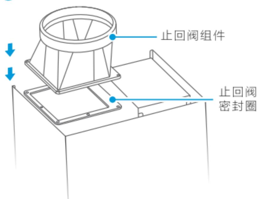
将止回阀组件连同止回阀密封圈安装在出风口位置，用随机配备的4个ST4.2 × 16的螺钉紧固，检查并确保阀片转动灵活。
