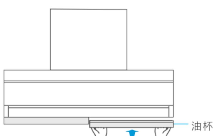
双手握住油杯底部两端，将左右两个油杯分别水平插入油杯支架卡槽中，并沿油杯支架向后推到限位处即可。
