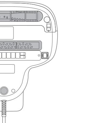
2. 借助放电板端部扣手槽向下旋转打开放电板，使用小毛刷或抹布对放电板进行清理。
