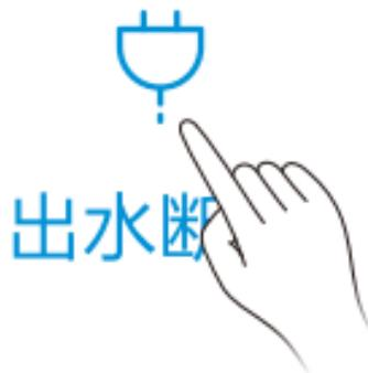
使用热水时，电热水器会自动切断电源，确保洗浴安全。
