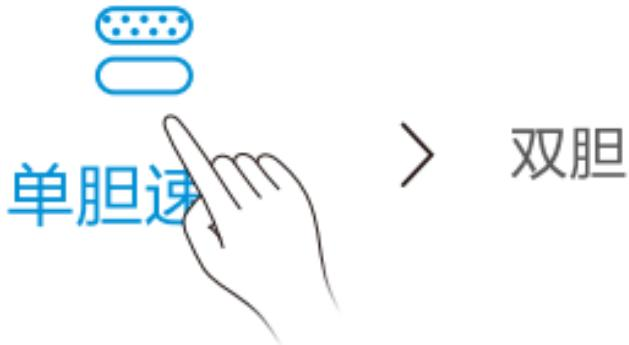
单击开启功能，热水器进入单胆/半胆速热状态，加热更快但热水量减少。
