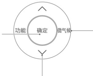
开机或关机状态下，按此键选择新风/加湿/净化/除菌，再按“确定”均可打开或关闭相应功能
