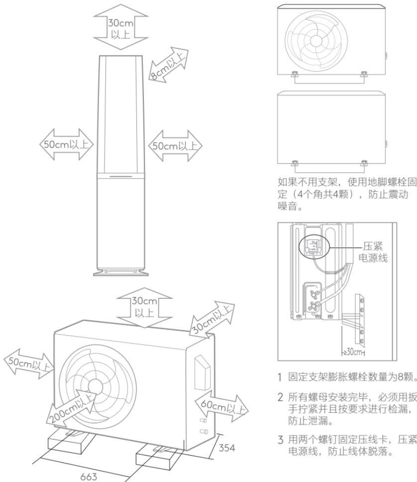
确保标配连接管和电缆线长度满足所选安装位置要求
