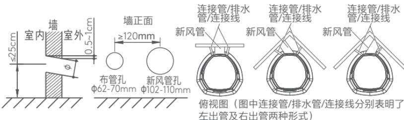
俯视图（图中连接管/排水管/连接线分别表明了左出管及右出管两种形式）
