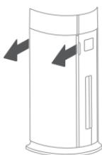
1 抓住下面板两侧扣手位，取下面板
