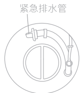
2 拉出紧急排水管
