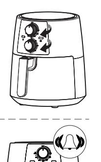
注: 当炸桶未完全推进, 微动开关未触发, 机器处于取桶断电状态, 不会进行工作, 此时只需将炸桶完全推进即可。
