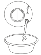
拔下紧急排水管堵头，将管内污水排至水盆或容器内后将堵头塞好
