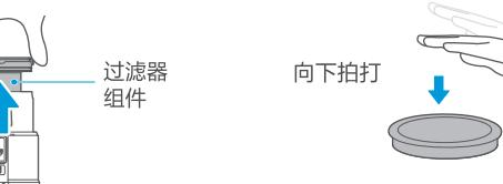
3. 按图所示旋转取下旋风器并清理；
