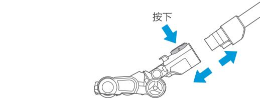
2. 按下按键，同时向上旋转侧盖；将侧盖与滚刷一起取出，对滚刷进行清洁，清洁完毕后与拆卸步骤相反装回。
