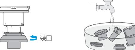
5. 水洗后需要充分晾干，然后按照拆卸相反顺序装回尘杯内。
