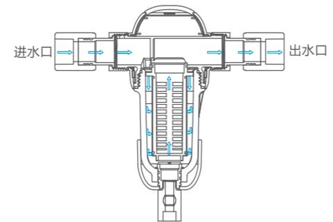
说明：原水由进水口进入过滤器，经过钢丝网内芯时，大颗粒杂质被拦截在钢网外表面，过滤后的水由出水口流出。
