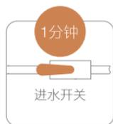
打开进水开关冲刷约1分钟后关闭进水开关
