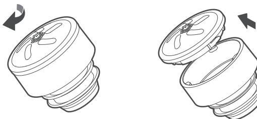
2 清洗完成后，将微压阀盖装入在微压阀座上，逆时针将其旋转拧紧。
