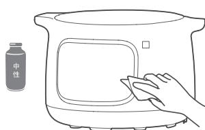
4 发热盘表面的油污,可以使用湿布清理,禁止直接倒入水和清洁剂擦洗。
