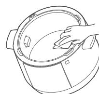
5 切勿将整个电炖锅放入水中清洗,请勿用水冲洗外锅,以免发生触电危险和功能故障。
