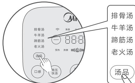
插上电源后，功能档位默认“排骨汤”档位，点击“汤品”按键可以选择面板左侧的“排骨汤”、“牛羊汤”、“蹄筋汤”以及“老火汤”四个功能，点击“特色”按键可以选择面板右侧的“杂粮粥”、“炖肉”、“甜品”和“再加热”四个功能。
