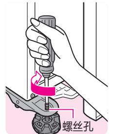
如转动调整脚仍不能调平冰箱的话，请在冰箱下面垫上垫板。
