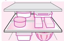
2 提起前段棚架的前侧往里推，可收起前段棚架
