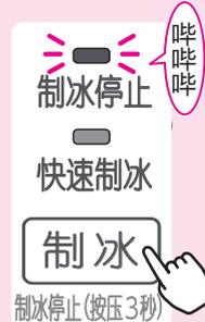
● 当设定为制冰停止时，残留在制冰盘中的冰或水完成制冰后，会落入贮冰盒中，并停止制冰。
