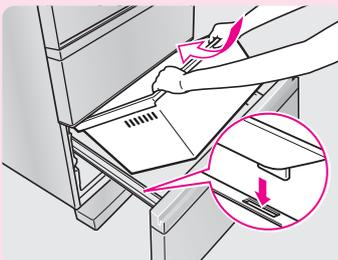
2 安装冷冻室下层滑动盒（第2步和第3步的操作可以反过来）
