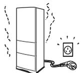
● 可燃气体（液化石油气、天然气等）泄漏时，请勿触摸冰箱或电源插头，应首先通风换气。否则，电器连接点的火花可能导致起火爆炸，引起火灾、受伤、烧伤。
