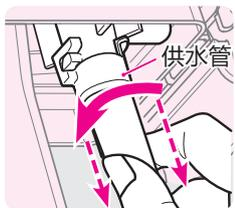
2 将供水泵从供水管拆下
