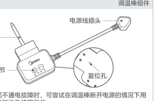
当产品出现不通电故障时，可尝试在调温棒断开电源的情况下用针状物按压复位孔按钮复位。
