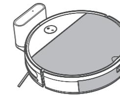
在清扫过程中, 主机能感知自身电量不足, 自主启动返回充电模式, 自动寻找充电座充电。也可以通过遥控器的返回充电键
