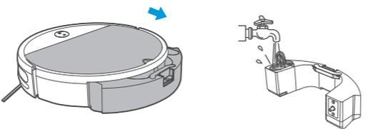
C. 把注水胶塞装平压紧 D. 水箱装回机器
