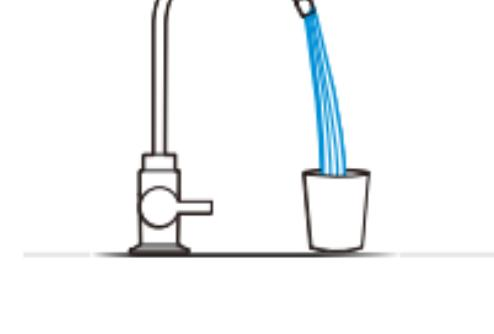
首次使用时前置和后置活性炭滤芯存在黑粉，需进行冲洗，打开水龙头放水30分钟，一切确认无误后，可以安全使用。
