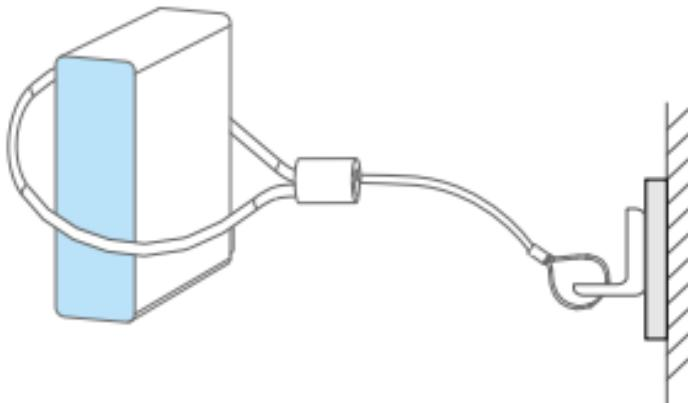
在净水机安装位置选取合适高度的墙体位置，在墙壁上钻孔并安装膨胀胶钉，然后用螺钉将安全绳上的吊码固定在墙上，另一端用六角锥将安全绳上的锁紧器螺钉松口形成一个大套圈，将产品套住，安装完毕确认机器固定牢固。
