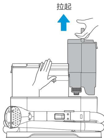
2 打开清水箱上盖，注入清水。若需进行深度清洁，倒入专用清洁液即可。安装好清水箱上盖，确保安装到位。
