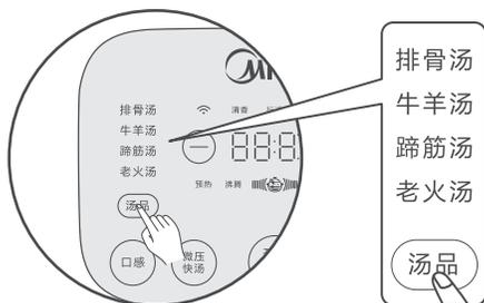
插上电源后，功能挡位默认“排骨汤”挡位，点击“汤品”按键可以选择面板左侧的“排骨汤”、“牛羊汤”、“蹄筋汤”以及“老火汤”四个功能，点击“特色”按键可以选择面板右侧的“杂粮粥”、“炖肉”、“甜品”和“再加热”四个功能（旋转旋钮也可以快速选择上述功能）。
