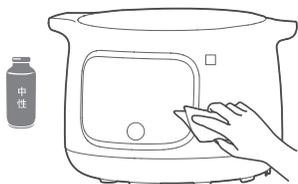
4 发热盘表面的油污，可以使用湿布清理，禁止直接倒入水和清洁剂擦洗。
