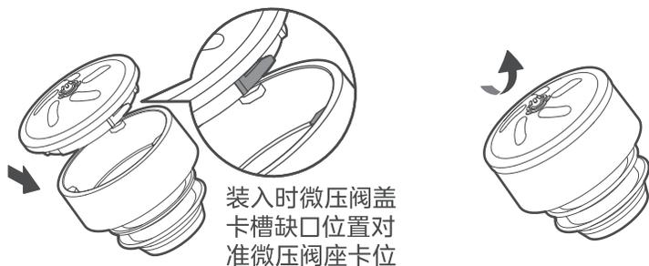
注：必须在微压阀完全冷却后，方可清洗，小心烫伤。
