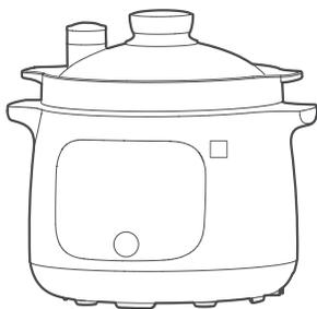
接通电源，数码管和指示灯点亮 1 秒，蜂鸣器提示一声，进入待机状态，数码管显示默认时间。
