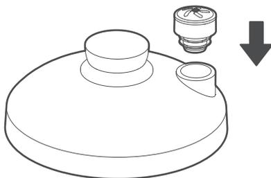
使用前将微压阀组件装入陶瓷盖上；将陶釜外表面以及外锅擦干，然后将陶釜放入电炖锅内。
