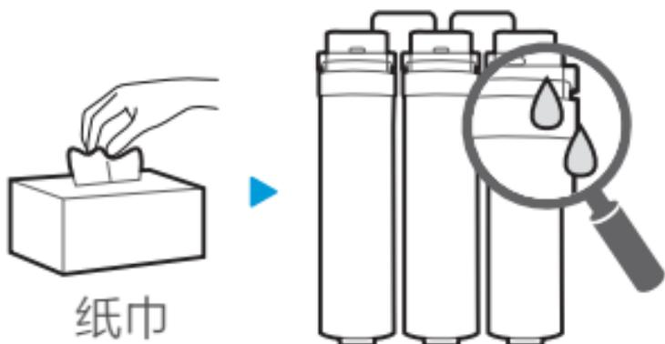
接通水源，使产品正常出水，并用干爽的纸巾检查各连接处是否有漏水现象。
