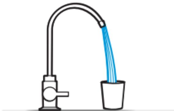
由于反渗透膜的亲水特性，膜内含有保湿成分（主要成分为食品级甘油），为了初装后产水的口感更佳，初装第一天尽可能使用机器，产水不建议饮用，可用于厨房清洗用水。若不能按以上操作，建议安装后每隔2小时打开水龙头制水20分钟并排掉，循环12次以上，以便充分保证口感，激活膜的性能。
