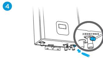
4 拧开安全阀排水，排完水后，装好安全阀即可。
