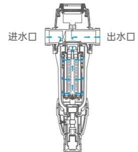
说明: 原水由进水口进入过滤器, 经过钢丝网内芯时, 大颗粒杂质被拦截在钢网外表面, 过滤后的水由出水口流出。
