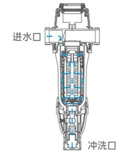
刮洗排污说明: 打开冲洗旋钮, 杂质由冲洗口排出。
