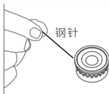
b | 将火孔中的污物和积碳刷干净。
