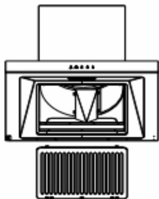
手扶滤网，用十字螺丝刀取下滤网上两颗滤网固定螺钉，打开滤网，打开后，双手扶住沿水平方向取出。
