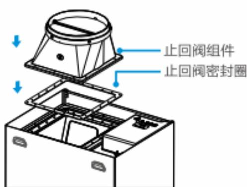
将止回阀组件连同止回阀密封垫安装在机架出风口位置,用出风口处已有的11颗M4×16的螺钉固定,检查并确保阀片转动灵活。
