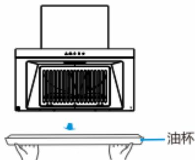
双手水平抽出油杯，倒掉油杯的积油。
