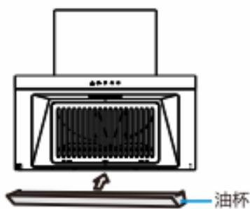
双手握住油杯底部两端,将油杯水平插入油杯支架卡槽中,并沿油杯支架往后推到限位处即可。
