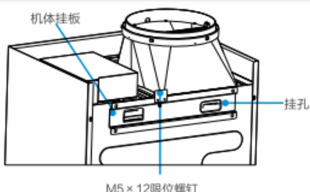
将机体后部的挂孔对准机体挂板的挂钩,从上往下挂入并确认机体安装水平和牢固,再将随机配备的M5×12三角牙自攻螺钉装入机体挂板顶部螺钉孔内,防止机器意外脱落。
