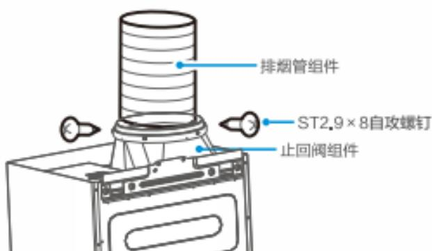
排烟管组件的一端装入止回阀出风口内,再将2枚ST2.9×8自攻螺钉固定(如图所示)然后用附件包配备的铝箔纸将排烟管粘在止回阀上;再将排烟管组件的另一端引入到室外或公共烟道接口。
