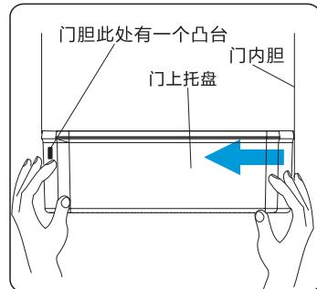
2 安装：双手扶住托盘的两侧，先将凸台的一侧卡扣安装到位，另一侧稍用力往外内推卡住卡扣即可。
