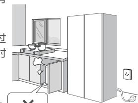
当煤气等易燃气体泄露时，应先关闭气体泄露阀门，再打开门窗，此时切勿拔下冰箱等电器插头，以免产生电火花引发火灾。
