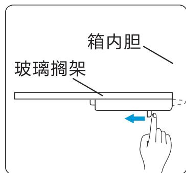
2 安装：回装的时候按照同样的方法，搁架插销对准箱胆内小孔即可。
