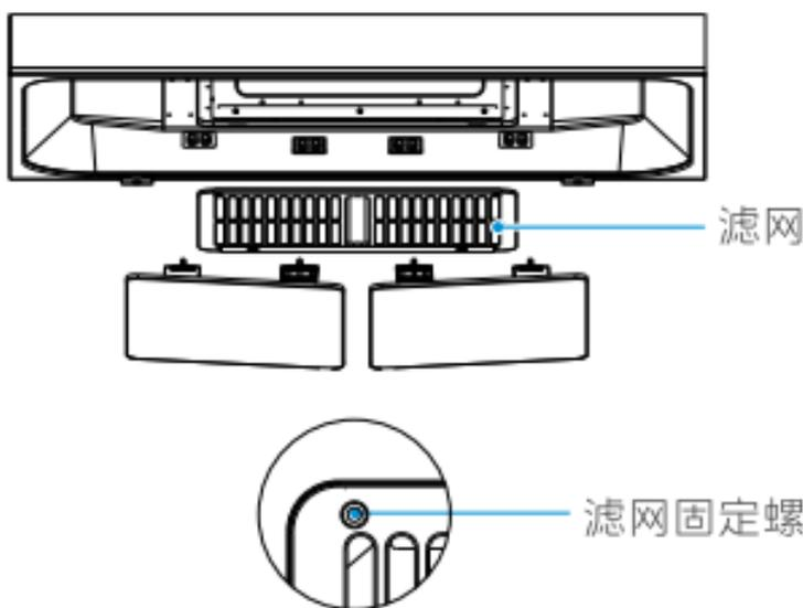
取出左右冷凝板,手扶住滤网,用十字螺丝刀取下滤网上两颗滤网固定螺丝,打开后,双手扶住取出滤网。
