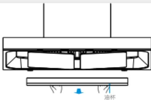
双手水平抽出油杯，倒掉油杯的积油。
