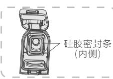
💡 温馨提示：合上蒸汽阀之前，请安装好蒸汽阀盖内侧的硅胶密封条。
