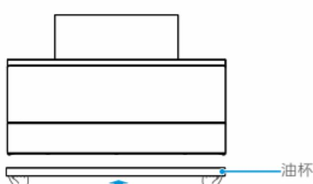
双手握住油杯底部两端，将油杯水平插入油杯支架卡槽中，并沿油杯支架往后推到限位处即可。
