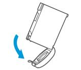
3. 按图示箭头方向拔出滤片组件，可进行滤片组件的清洁或更换；
