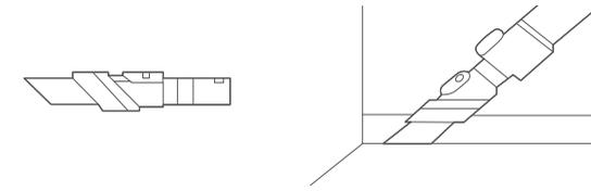
将二合一附件的毛刷头向后推，当听到“咔”声，即为固定住，即可清理墙角、楼梯、键盘等的缝隙。
