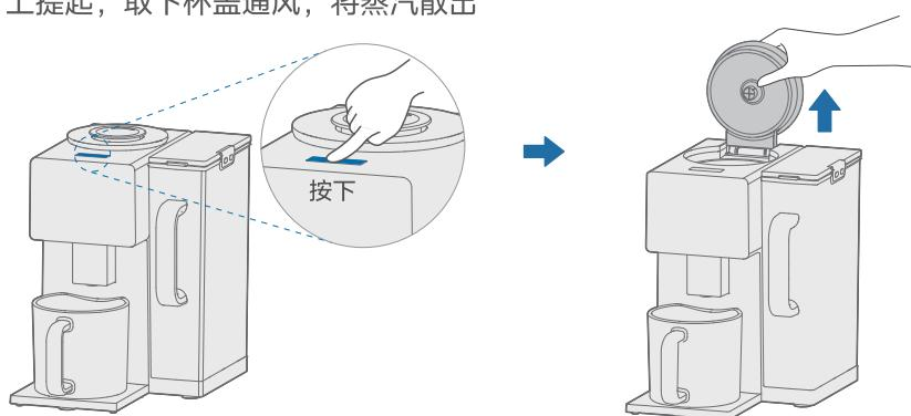
**2** 产品使用后，断开电源，请拆开蒸汽阀手动冲洗，请勿将杯盖浸泡到水或其他液体中
