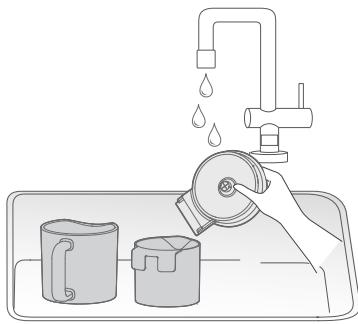
**5** 多次使用后，若杯壁出现少量残留，建议在断电及杯内冷却的情况下用湿毛巾擦拭内壁，然后用“除菌洗”功能再次清洗杀菌
