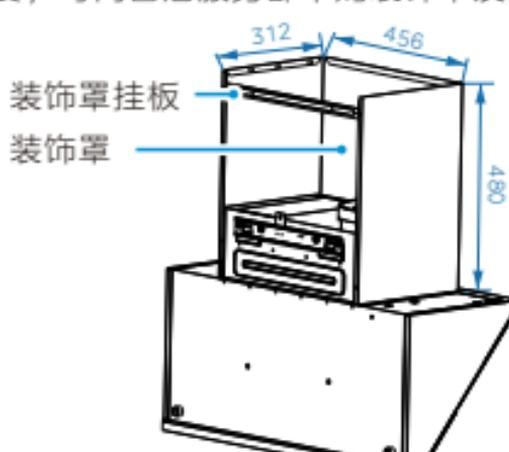
先用ST4x8十字槽自攻螺钉将装饰罩挂板固定到装饰罩背面的安装孔上，再将装饰罩放置在箱体顶部，使装饰罩底部安装孔与箱体顶板相应安装孔位对齐，用配备的4颗ST4x8螺钉将装饰罩固定在箱体顶部。
