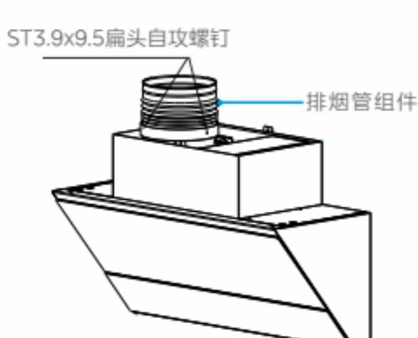
排烟管组件的一端装入止回阀出风口内，再将2枚ST3.9x9.5扁头自攻螺钉固定（如图所示），然后用附在烟管的铝箔胶带将排烟管粘在止回阀上；再将排烟管组件的另一端引入到室外或公共烟道接口。
