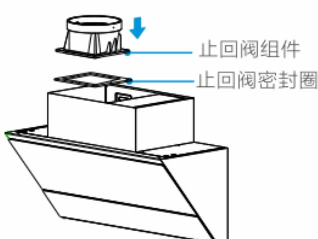
将止回阀组件连同止回阀密封圈安装在出风口位置，用随机配备的4枚 $\Phi 5$ 平垫和4颗ST4x16的螺钉紧固，检查并确保阀片转动灵活。
