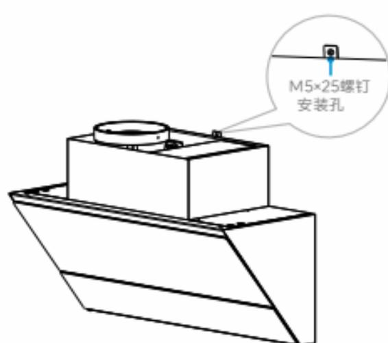
将机体后部的挂孔对准机体挂板的挂钩，从上往下挂入确认机体安装水平和牢固，再将随机所附的M5x25螺钉装入机体挂板顶部螺丝孔内，防止机器意外脱落。
