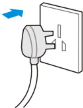
将电源插头插入插座，蜂鸣器提示一声，上面板自动开合，一次自检后，整机进入待机状态。
