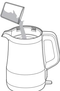
**2** 通电源将除垢剂溶液烧开
