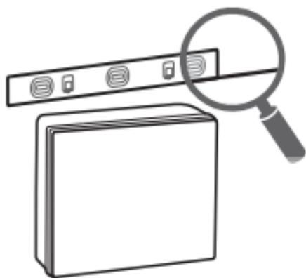
壁挂式安装应检查壁挂吊板、螺钉是否松动。
