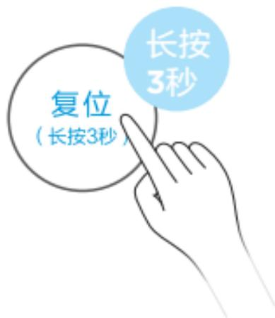
更换滤芯后，重新通水通电，长按显示板上面的[复位]键3秒进行复位。
