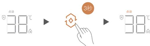
② 点动开启状态下，5秒内开关2次水龙头（热水端）或花洒（热水端），将会触发热水器启动零冷水预热。
