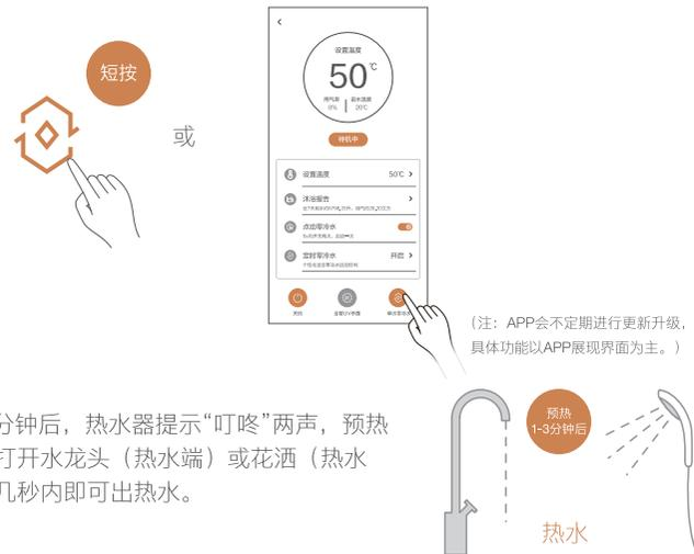
② 1-3分钟后，热水器提示“叮咚”两声，预热完成。打开水龙头（热水端）或花洒（热水端），几秒内即可出热水。
