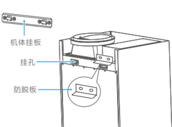
机体后部的挂孔对准机体挂板的挂钩，从上往下挂入确认机体安装水平和牢固，然后在墙上开2个10mm孔，将塑料膨胀管压入孔内，再用随机配备的ST5X50扁头自攻螺钉装入防脱板螺丝孔内，防止机器意外脱落。
