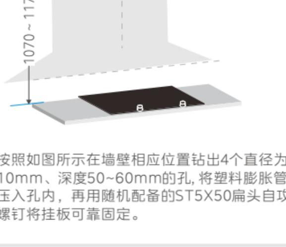
按照如图所示在墙壁相应位置钻出4个直径为10mm、深度50~60mm的孔，将塑料膨胀管压入孔内，再用随机配备的ST5X50扁头自攻螺钉将挂板可靠固定。
