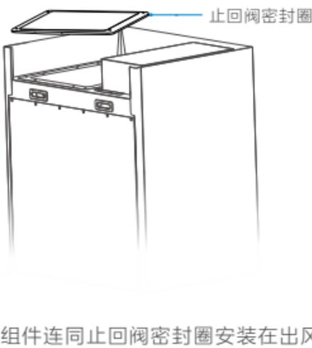
将止回阀组件连同止回阀密封圈安装在出风口位置，用随机配备的8颗M4×16的螺钉紧固，检查并确保阀片转动灵活。
