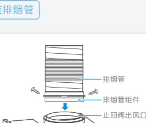
排烟管组件的一端装入止回阀出风口内，再将2枚ST4.9x9.5扁头自攻螺钉固定(如图所示)，然后用附在烟管的铝箔胶带将排烟管粘在止回阀上;再将排烟管组件的另一端引入到室外或公共烟道接口。
