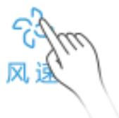
待机状态下轻触风速键使控制面板打开。
