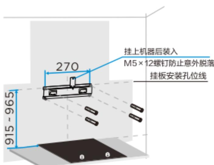
按图所示在墙壁相应位置钻出4个直径为8mm、深度为60-70mm的孔，将塑料膨胀管压入孔内，再用随机配备的5×60十字大扁头木螺钉将机体挂板可靠固定。
