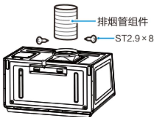
排烟管组件的一端装入止回阀出风口内,再将2枚ST2.9×8自攻螺钉固定(如图所示)然后用附件包配备的铝箔纸将排烟管粘在止回阀上;再将排烟管组件的另一端引入到室外或公共烟道接口。
