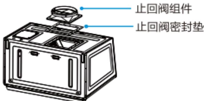
将止回阀组件连同止回阀密封垫安装在机架出风口位置,用出风口处已有的11颗M4×16的螺钉固定,检查并确保阀片转动灵活。
