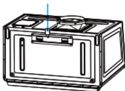
将机体后部的挂孔对准机体挂板的挂钩,从上往下挂入并确认机体安装水平和牢固,再将随机配备的M5×12三角牙自攻螺钉装入机体挂板顶部螺钉孔内,防止机器意外脱落。
