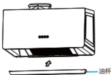
双手握住油杯底部两端,将油杯水平插入油杯支架卡槽中,并沿油杯支架往后推到限位处即可。
