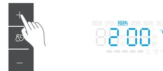
3 预热结束后，拉门放入食物，拉开门后默认进入烘烤或空气炸状态，温度默认为预热完成温度，按【确定/开始】键进入时间设置界面，重复或叠加按【10秒/1分/5分】选择时间。
