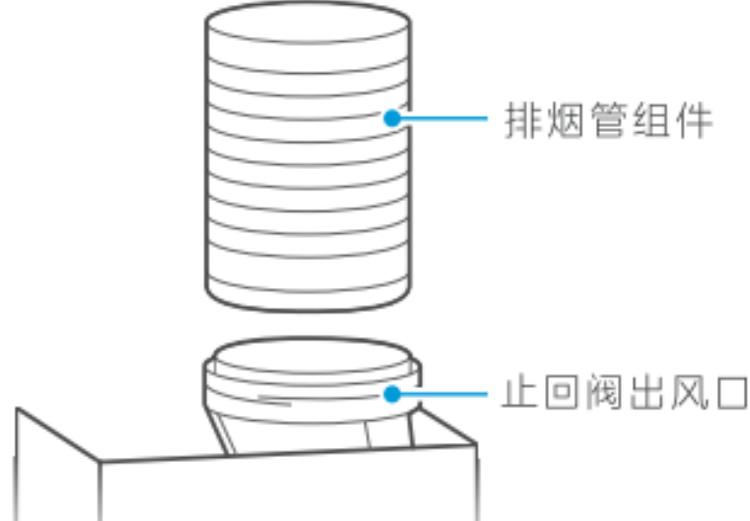
将排烟管一端插入止回阀凹槽内，用随机配送的ST2.9×9.5自攻螺钉将排烟管固定在止回阀中，再用排烟管上的铝箔胶带缠绕在止回阀与排烟管的安装接头处。再将排烟管的另一端引至室外或者公共烟道中。
