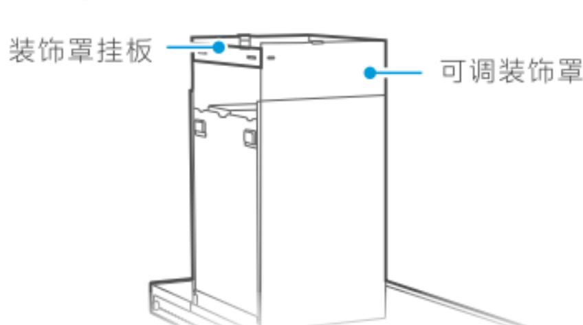
根据可调装饰罩所需安装高度，在墙壁相应位置钻出2个直径为8mm、深度为50mm的孔，将膨胀管压入孔内，再用随机配备的2颗M5×50沉头木螺钉将装饰罩挂板可靠固定。将可调装饰罩调至对应高度，并用随机配备的ST4.2×9.5自攻螺钉紧固在挂板上。
