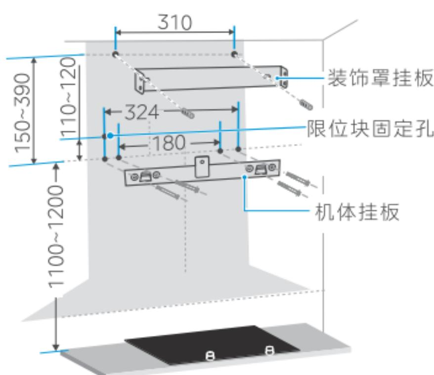
按图示在墙壁相应位置钻出5个直径为10mm，深度为50-60mm的孔，其中上侧的单独孔用来固定限位块。将塑料膨胀管压入孔内，再用随机配备的5×50沉头木螺钉将机体挂板可靠固定。
