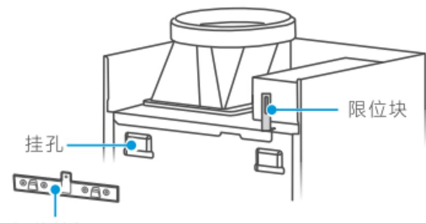
将机体后部的挂孔对准机体挂板的挂钩，从上往下挂入确认机体安装水平和牢固，将限位块顶住烟机，并用M5\*45扁圆头螺钉将限位块可靠固定，防止机器意外脱落。
