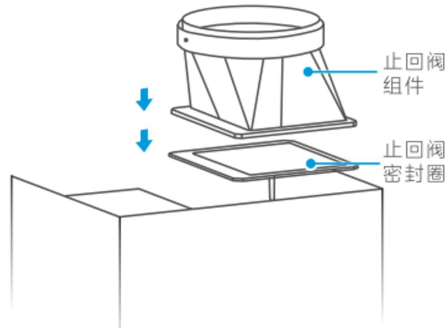
将止回阀组件连同止回阀密封圈安装在出风口位置，用随机配备的6个ST4.2×16的螺钉紧固，检查并确保阀片转动灵活。
