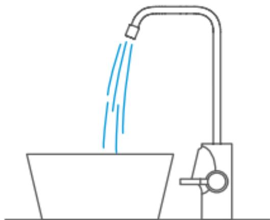
安装好新滤芯后，打开水龙头放水冲洗15分钟，直至出水端没有黑水。
