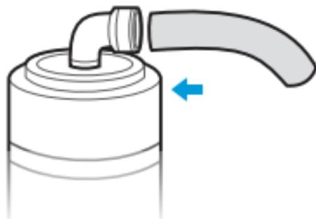
检查机器关键零部件的连接逐个用力将连接处的PE管顶一下，确保PE管插到位。
