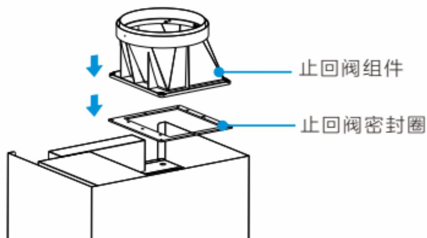
将止回阀组件连同止回阀密封圈安装在出风口位置，用随机配备的ST4x16的自攻螺丝固定，检查并确保阀片转动灵活。
