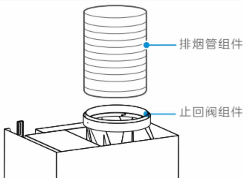
排烟管组件的一端装入止回阀出风口内，再将2枚ST2.9x9.5扁头自攻螺钉固定（如图所示），然后用附在烟管的铝箔胶带将排烟管粘在止回阀上；再将排烟管组件的另一端引入到室外或公共烟道接口。
