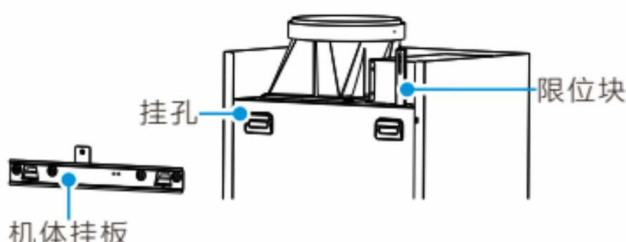
将机体后部的挂孔对准机体挂板的挂钩，从上往下挂入确认机体安装水平和牢固，再将限位块顶住烟机，并用5x50十字槽扁头木螺顶将限位块可靠固定，防止机器意外脱落。
