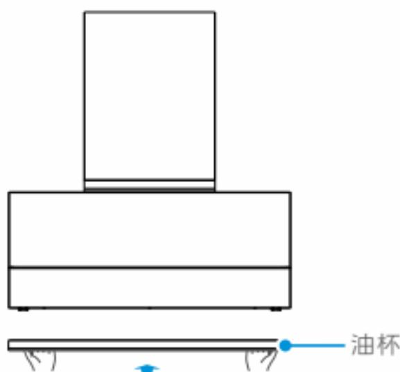
双手握住油杯底部两端，将油杯水平插入油杯支架卡槽中，并沿油杯支架往后推到限位处即可。
