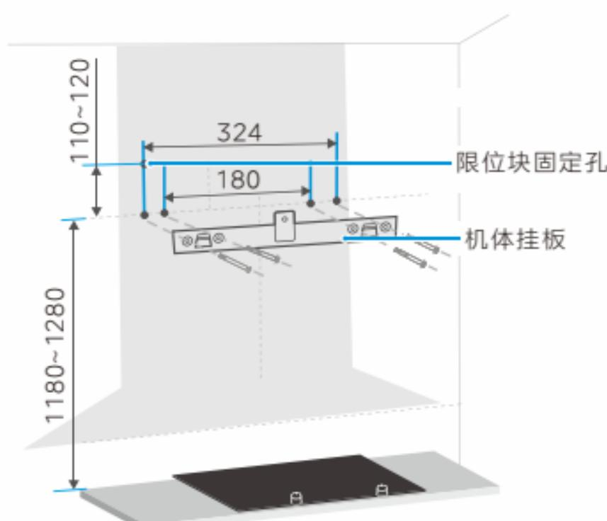
按照如图所示在墙壁相应位置钻出5个直径为10mm、深度50~60mm的孔，其中上侧的单独孔用来固定限位块。将塑料膨胀管压入孔内，再用随机配备的5x50沉头木螺钉将挂板可靠固定。
