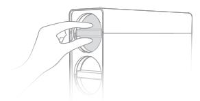
⑤ 旋紧滤芯至标识位置，盖上滤芯装饰盖。滤芯更换完毕后，重新通水通电，长按[复位]按键3秒，直到滤芯提示灯停止闪烁。
