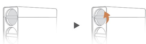
④ 取出需要更换的滤芯，将滤芯放入滤芯套筒内，顺时针旋至标识位置。
