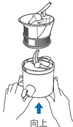
**4 拆卸螺旋推进器**
