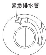
拉出紧急排水管
